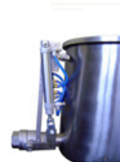
Control automático de nivel de tolva.
