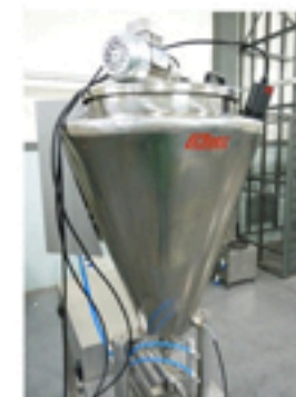
Tolva con calefacción y agitador.
